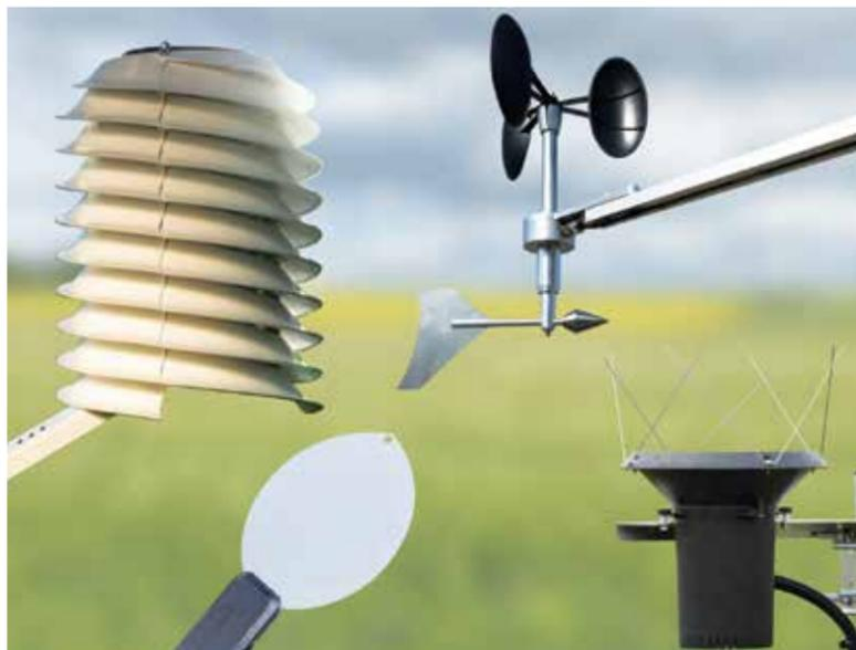
feuchte, Luftdruck, Globalstrahlung, Niederschlag und Wind auch die agrarmeteorologisch relevanten Parameter Blattfeuchte, Bodentemperatur, bodennahe Temperatur sowie den Bodenwassergehalt erfassen.
